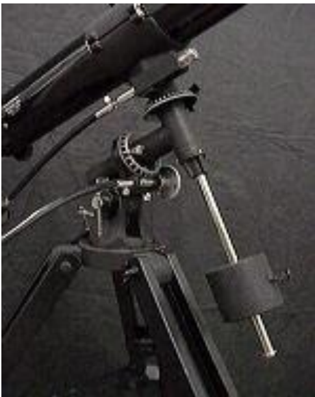
Slika 5: Nemška ekvatorialna nastavitvev.
