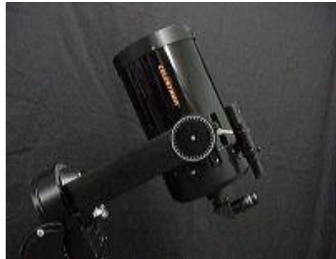
Slika 6: Angleška ekvatorialna nastavitvev.
