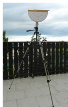
Slika 9: Višinomer, pritrjen na stativ.
