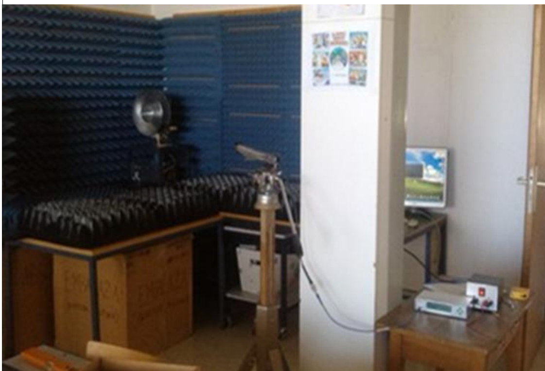
Slika 3: Celotna postavitve naprave za testiranje anten. Sprejemna antena (levo), oddajna LPDA antena (sredina) ter visokofrekvenčni generator in napajalnik (desno).
