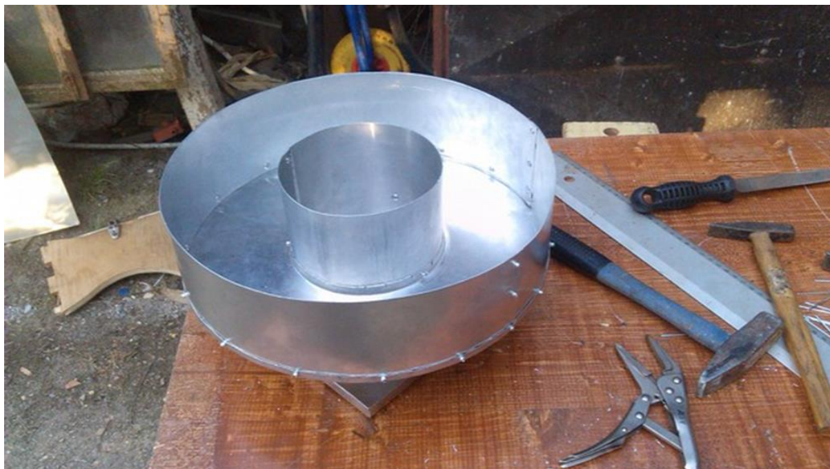
Slika 1: Izgradnja žarilca tipa Kumar-K4 za sprejem signala molekule OH pri valovni dolžini 18 cm, v katerem je vgrajena sprejemna antena. Žarilec bo postavljen v gorišču parabole.
