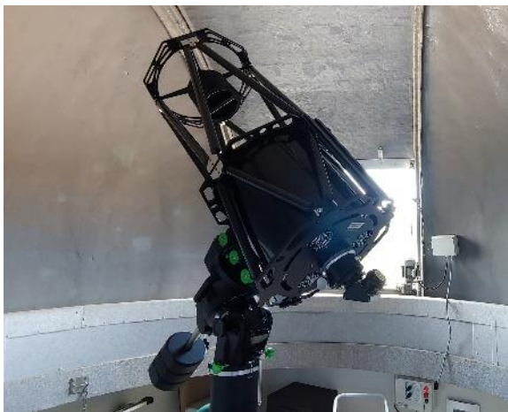
Slika 4: Teleskop Ritchey-Chrétien, s premerom 35 cm.
